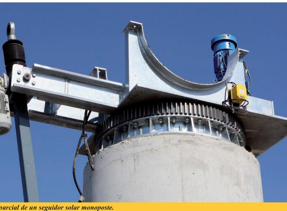
*Parcial de un seguidor solar monoposte.*
