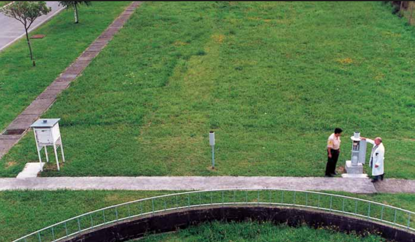
Juan Romero y un vigilante junto al pluviógrafo, en Treto (en el centro de la foto aparece el pluviómetro; y, a la izquierda, la garita, o abrigo termométrico). Abajo, el técnico muestra el diploma otorgado por el Instituto Nacional de Meteorología.
