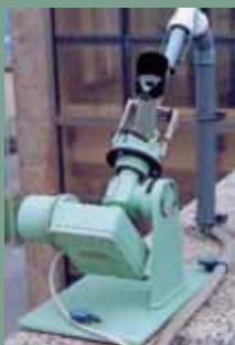
Instrumentos para medir la radiación global y la directa.
