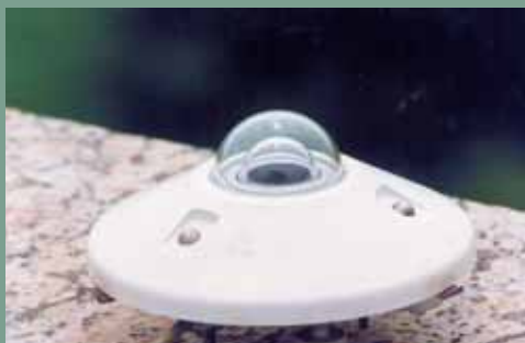
Instrumentos para medir la radiación global y la directa.
